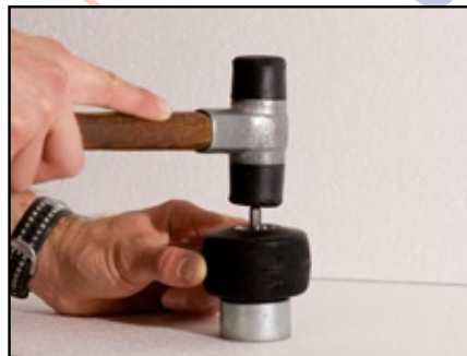
3. Legg hjulet på underlag og slå ut aksel med gummuklubbe hylse.
