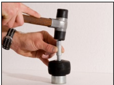
5. Snu hjulet rundt og slå ut kulelager på motsatt side med dor.
