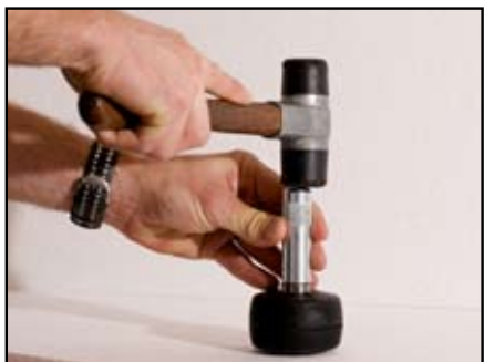
9. Slå in kullagret med en hylsa. Sätt tätningsbrickor på båda sidor. Sätt mutter på båda sidor
