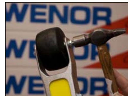
12. Slå ett par lätta slag på var sida på hjulbulten så ev. spänningar i hjulet släpper och kontrollera att det rullar lätt.
