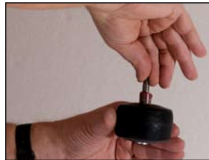
7. Vänd hjulet och sätt in axeln.
