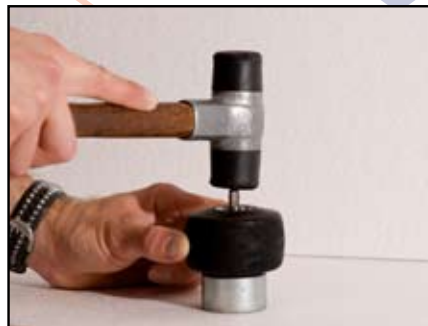
3. Lägg hjulet på underlägg och slå ut axeln med gummiklubba.
