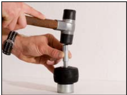
5. Vänd hjulet och slå ut kullagret på motsatta sidan men en don
