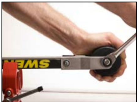
1. Lossa muttrarna och ta av hjulet
