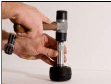
6. Lägg ett tunt lager fett på sidoväggarna för kullagren i navhylsan. Slå in ena kullagret med en hylsa.
