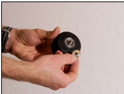
2. Tag av tätningsbrickorna på båda sidor
